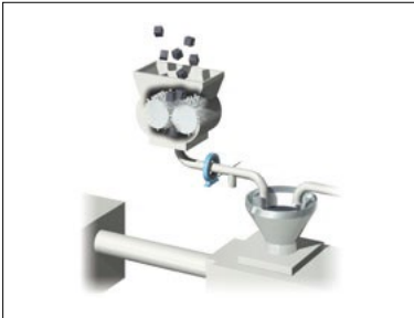
Detección de metal en el material de moldeo Verificación de dientes de trituración y pernos astillados entre el plástico triturado.
