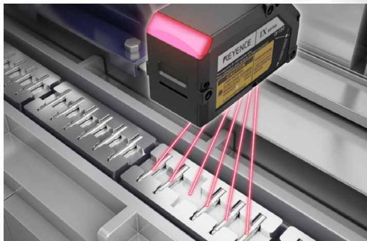
Verificación de cantidad de partes
