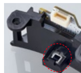
Fotodiodo y circuito de corrección dentro de la iluminación
