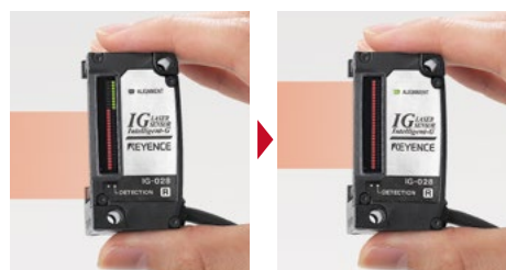
Alineación del eje óptico en curso
