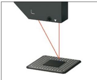
Medida de la forma de una BGA
