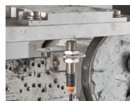
Pruebas de resistencia a impactos usando impactos directos al sensor
