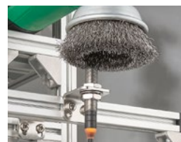
Prueba de resistencia a la abrasión utilizando un cepillo de acero girando a 2800 rpm
