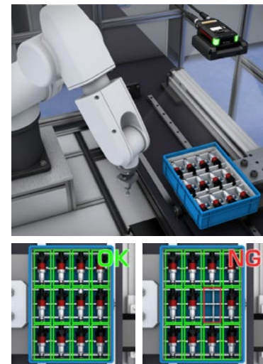
Comprobación de la cantidad de inyectorores
