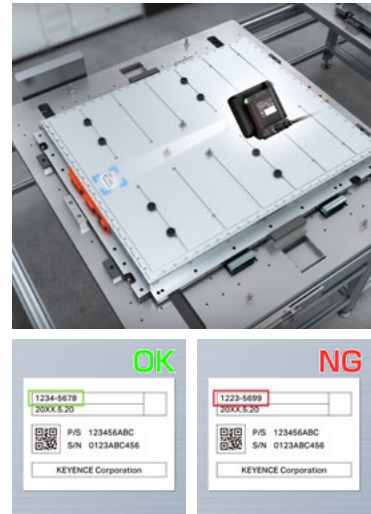
Comprobación del número de lote de la batería de iones de litio
