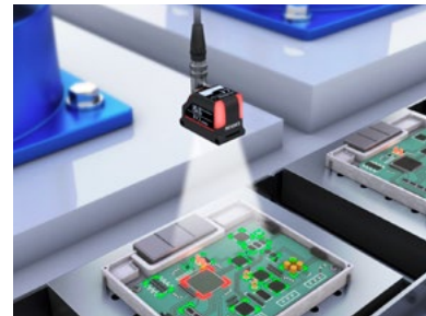
Inspección de componentes de PCBs faltantes
