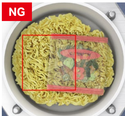
Comprobación de presencia de bolsitas de fideos en taza
