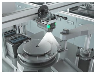
Comprobación de defectos tras la extracción del molde de inyección
