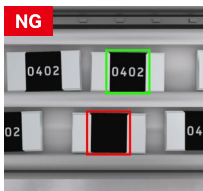
Diferenciación superior/inferior de resistencias SMD
