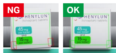
Comprobación de defectos en la forma de las cajas farmacéuticas
