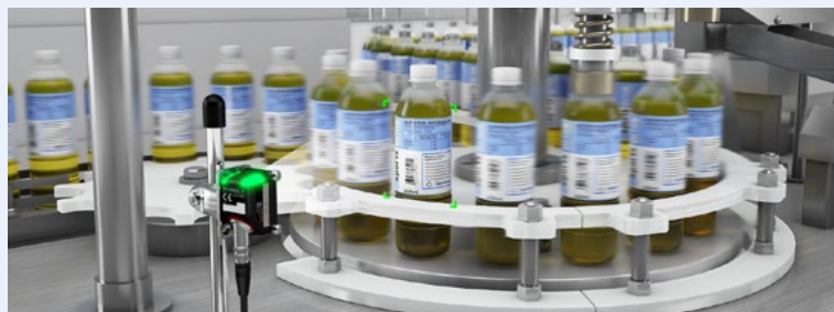
Diferenciación de etiquetas de botellas de plástico
