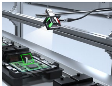
Orientación de palés/comprobación de cantidades para el suministro de material
