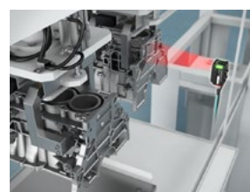
Lectura de las piezas del motor durante el transporte en una grúa pórtico
